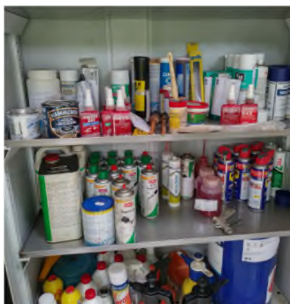
Figure 67 : Dépôts de liquides inflammables en petits conditionnements (source : Sertius SA)
