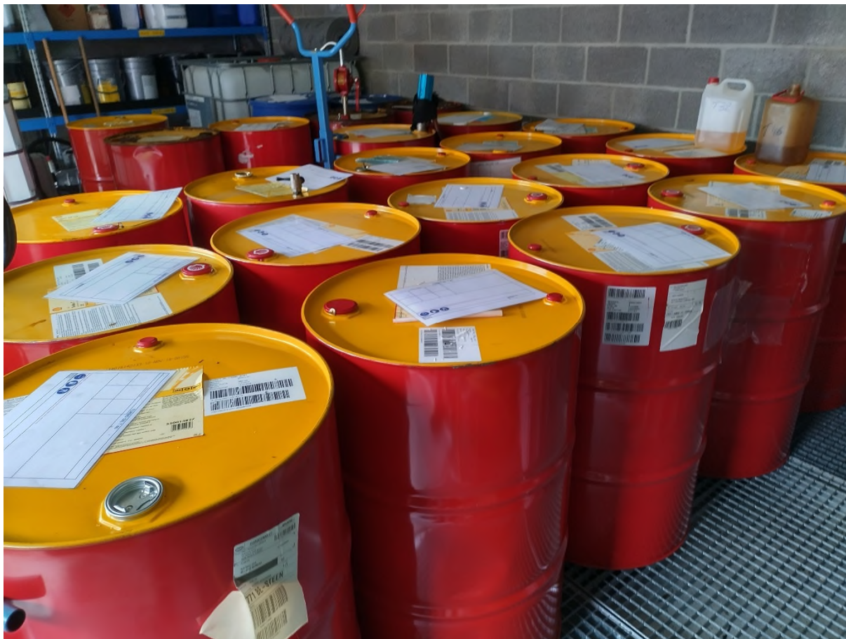
Figure 68 : Dépôts d'huiles neuves dans un hangar placé sur rétention (source : Sertius SA)
